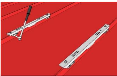
Fissare i 4 morsetti, precedentemente collegati ai 2 profili ad U, mediante 4 viti M8X16, e serrare gli 8 grani a 20Nm con l'inserto T-30.
