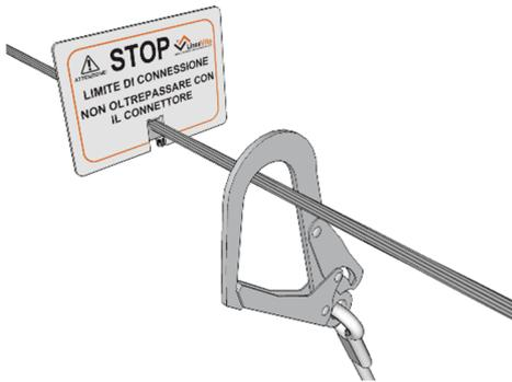
Il limitatore deve essere collocato in modo che la parte stampata sia rivolta verso l'interno della linea (dove scorre l'ancoraggio mobile o il connettore).
