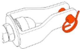
Rimuovere la coppia di sicurezza presente nella forcina del tenditore e rimuovere il perno di fissaggio. Collegare mediante il connettore rimosso in precedenza dal dissipatore HL305 il tenditore HL404 all'elemento di estremità scelto.
