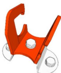
Posizionare l'assieme sulla struttura di supporto, tracciare la posizione dei fissaggi e mediante n.2 ancoranti fissarlo alla struttura.
