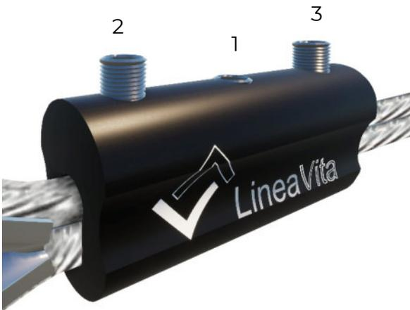
Serrare per prima la vite a brugola n.1 (quella centrale) a 20Nm con l'inserto HW5 o la chiave a brugola 5 mm.
