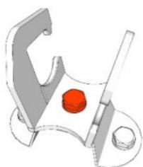
Posizionare l'elemento intermedio sopra al supporto mediante la vite T.E. M12x30 (compresa nel codice) rendere solidali i due componenti. Serrare la vite T.E. M12 precedentemente rimossa.
