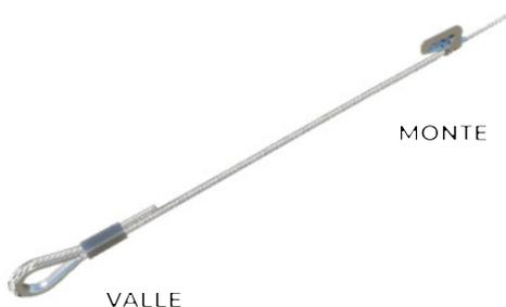
Posizionare il cavo L 5.00 m con il manicotto "a valle" in modo che crei un blocco all'ultimo punto di ancoraggio qualora esso venisse installato in maniera errata e possa scivolare in caso di caduta dell'operatore. Non utilizzare il manicotto come punto di ancoraggio a cui collegare i DPI.
