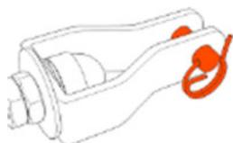
Rimuovere la coppiglia di sicurezza e rimuovere il perno di fissaggio. Collegare il tenditore HL400 al connettore presente nell'elemento di estremità scelto.
