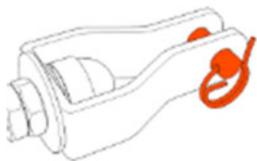
Rimuovere la coppia di sicurezza presente nella forcina del tenditore e rimuovere il perno di fissaggio. Collegare mediante il connettore rimosso in precedenza dal dissipatore HL305 il tenditore HL404 all'elemento di estremità scelto.
