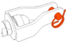
Rimuovere la coppiglia di sicurezza e rimuovere il perno di fissaggio. Collegare il tenditore HL404 al connettore presente nell'elemento di estremità scelto.
