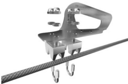
Predisporre i punti di ancoraggio sul cavo (orientandoli in maniera corretta) mediante n. 2 morsetti vincolarli al cavo. Applicare il dado ed il dado cieco in dotazione per serrare.
