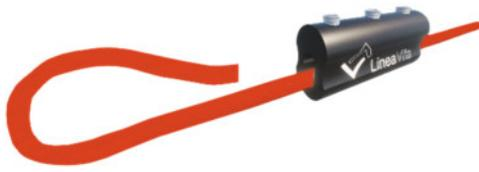
Inserire la fune nel serracavo in alluminio Block per circa 30 cm, risvoltarla ed inserire il capo morto verso il lato con le 3 viti a brugola.
