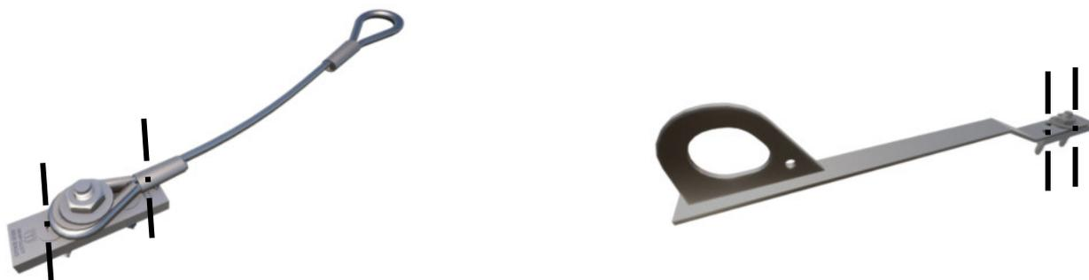
Assemblare l'elemento Wood con il dispositivo di ancoraggio di tipo A scelto mediante la vite T.P.S.E.I. 12x40 e la relativa bulloneria. A fine installazione serrare il bullone M12 e l'inserto a brugola (8 mm) per M12. Mediante i 2 fori  $\varnothing$  11 eseguire il fissaggio alla struttura di supporto.
