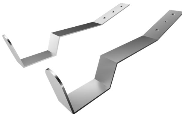
Fissare i ganci scala mediante idoneo fissaggio (utilizzando i fori  $\varnothing 12/8$  mm presenti), regolando la sporgenza in funzione dell'ingombro del canale di gronda e regolando l'interasse dei supporti in funzione della larghezza della scala in dotazione all'edificio.
