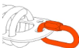
Aprire la ghiera dell'altro connettore HL090 presente sul dissipatore HL305 e inserire la testa del cavo con manicotto nel connettore HL090 e serrare la fascetta con chiave 14.
