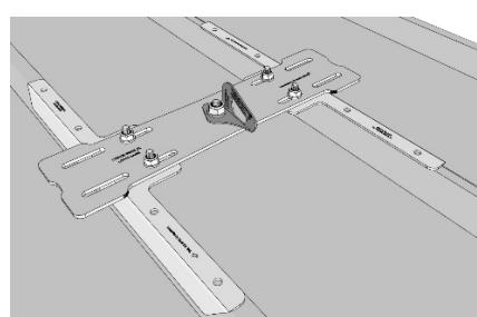
Collegare la piastra (precedentemente assemblata con il punto di ancoraggio) agli angolari mediante le 2+2 viti V.T.T.Q.S.T. M8x25 con rondelle e dadi.
