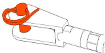
Rimuovere il secondo connettore HL090 dall'altra estremità del dissipatore di energia, per utilizzarlo successivamente. Rimuovere la coppiglia di sicurezza ed il perno di fissaggio della forcella pressata sulla testata del cavo. Inserire il cavo nella cannula eseguendo 5 pressature iniziando dal lato della forcella avendo cura che le pressature siano equidistanti.
