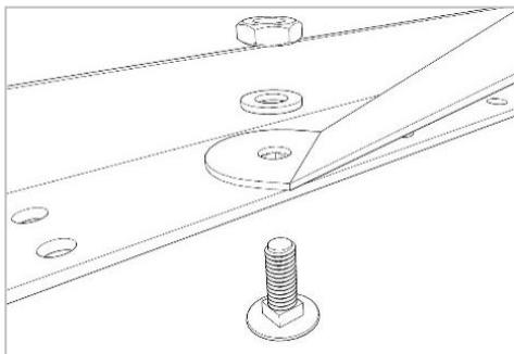
Assemblare la parte centrale agli angolari mediante i 4 V.T.T.Q.S.T. M8x16.
