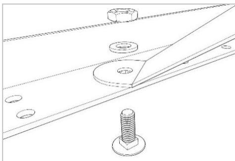
Assemblare la parte centrale agli angolari mediante le 4 V.T.T.Q.S.T. M8x16.
