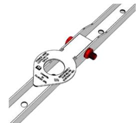
Sulla base del tracciamento effettuato, posizionare il dispositivo di ancoraggio sulla copertura metallica.
