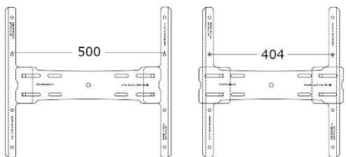
Assemblare il punto di ancoraggio alla piastra utilizzando la bulloneria M12.
