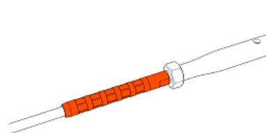
Inserire la testata del cavo nella cannula del tenditore fino a fine corsa. Eseguire n. 5 pressature della cannula iniziando dal lato filettato in successione, avendo cura che le pressature siano equidistanti.
