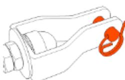
Rimuovere la coppia di sicurezza e rimuovere il perno di fissaggio. Collegare il tenditore HL400 al connettore presente nell'elemento di estremità scelto.
