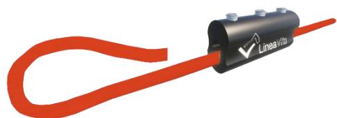
Inserire la fune nel serracavo in alluminio Block per circa 30 cm, risvoltarla ed inserire il capo morto verso il lato con le 3 viti a brugola.
