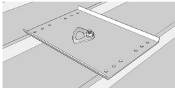
Posare la piastra assemblata sulle greche della lamiera, avendo cura di far aderire in modo uniforme il mastice esercitando pressione sulla piastra.
