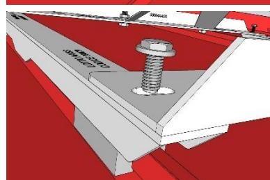
Rimuovere le 4 viti M8X16, posizionare l'elemento Anchor X, precedentemente assemblato sui 2 profili ad U, e serrare le 4 viti M8x16.
