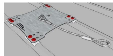
Procedere con la foratura della lamiera di supporto con punta da ferro Ø 8 mm. Inserire i rivetti in dotazione nei fori predisposti e installarli.
