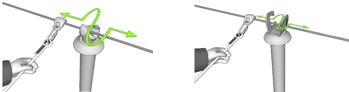
Per superare l'intermedio HL202 e HL2025 è sufficiente inserire ed inclinare la navetta all'interno dell'intermedio.
