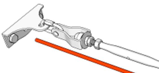
Svolgere il cavo fino all'estremità finale, assecondando il senso di avvolgimento, per evitare la creazione di "accavallamenti sul cavo"; accostare il cavo al tenditore per individuare il punto di installazione del serracavo in alluminio Block, avendo cura di tendere sia il cavo che il tenditore.
