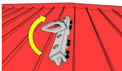
Ruotare il dispositivo di ancoraggio per agevolare l'inserimento del dispositivo sulla greca della lamiera aggraffata.
