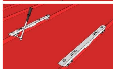
Fissare i 4 morsetti, precedentemente collegati ai 2 profili ad U, mediante 4 viti M8X16, e serrare gli 8 grani a 20Nm con l'inserto T-30.
