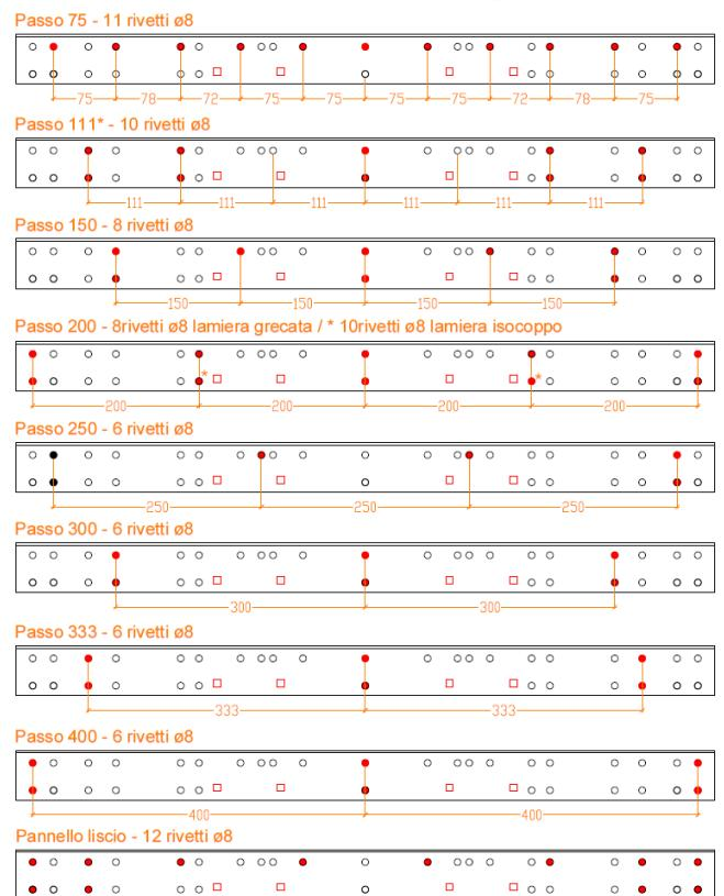
\* Per l'installazione dell'angolare su lamiera con passo 111 mm è necessario intervenire sulla lamiera per eliminare l'interferenza con la testa della vite sottotesta quadrata.
