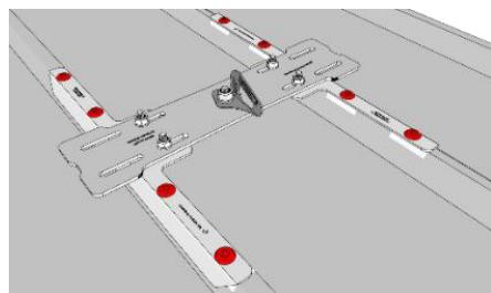
Posizionare gli angolari sulle greche della lamiera e fissarli con 4 + 4 rivetti, assicurandosi di metterli perfettamente a squadro per garantire il corretto allineamento nelle fasi successive dell'installazione.
