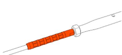
Inserire la testata del cavo nella cannula del tenditore fino a fine corsa. Eseguire n. 5 pressature della cannula iniziando dal lato filettato in successione, avendo cura che le pressature siano equidistanti.
