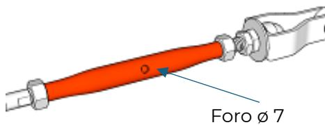
Agire sulla cannula del tenditore per tensionare il cavo. Utilizzare una leva da inserire nell'apposito foro Ø7 predisposto nel centro della cannula per facilitare le operazioni di tensionamento e consentire il successivo serraggio dei controdadi con chiave 22.
