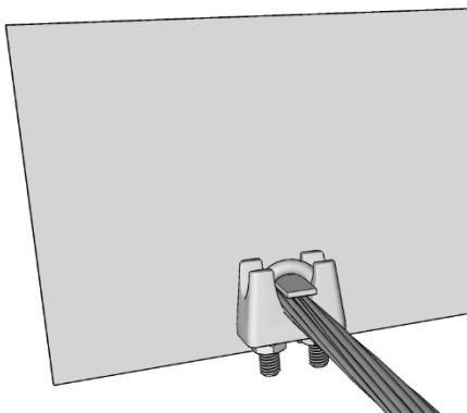
Fissare il limitatore al cavo utilizzando il morsetto fornito in dotazione, interponendo la linguetta in alluminio della targhetta (piegata in precedenza) tra la parte ad U ed il cavo. Serrare i 2 dadi M6.
