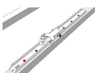
Procedere con la foratura della lamiera di supporto con punta da ferro Ø8 mm. Inserire i 6 rivetti in dotazione nei fori predisposti e installarli.
