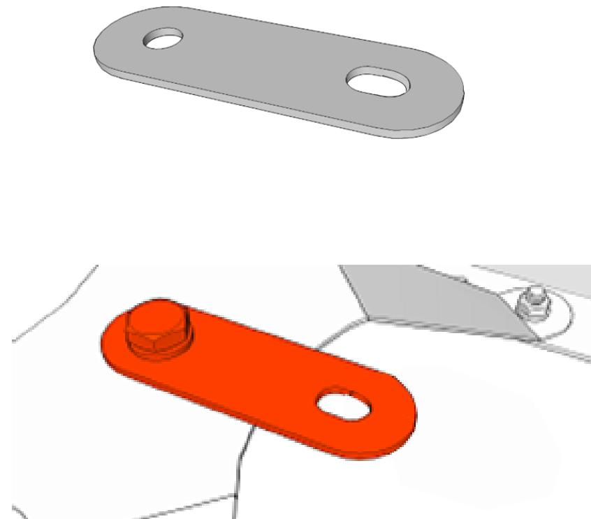
Posizionare la piastra di ancoraggio per paletti HL5020, mantenendo la marcatura rivolta verso l'alto, sopra all'elemento Anchor X. Unire i due pezzi mediante la vite T.E. M12 A2-70 presente nei codici 09085-09090.
