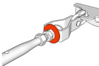
Per il corretto tensionamento controllare l'apposito disco (dotato di molle a tazza) presente sul tenditore che al raggiungimento del tensionamento minimo risulterà libero di ruotare. Il tensionamento dovrà essere compreso tra 0,8 e 1,5 kN.
