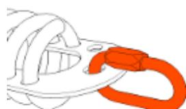
Aprire la ghiera dell'altro connettore HL090 presente sul dissipatore HL305 e inserire la testa del cavo con manicotto nel connettore HL090 e serrare la fascetta con chiave 14.
