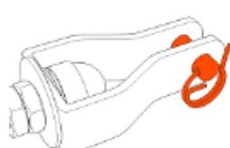
Rimuovere la coppiglia di sicurezza presente nella forcella del tenditore e rimuovere il perno di fissaggio. Collegare mediante il connettore rimosso in precedenza dal dissipatore HL305 il tenditore HL404 all'elemento di estremità scelto.
