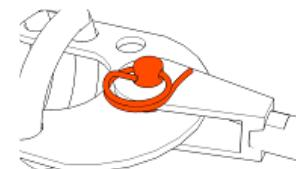
Fissare il cavo dall'estremità dotata di forcella pressata al foro della flangia del dissipatore HL305, assicurandosi di vincolare anche l'indicatore di caduta. Inserire il perno di fissaggio e la coppiglia di sicurezza nella forcella pressata.
