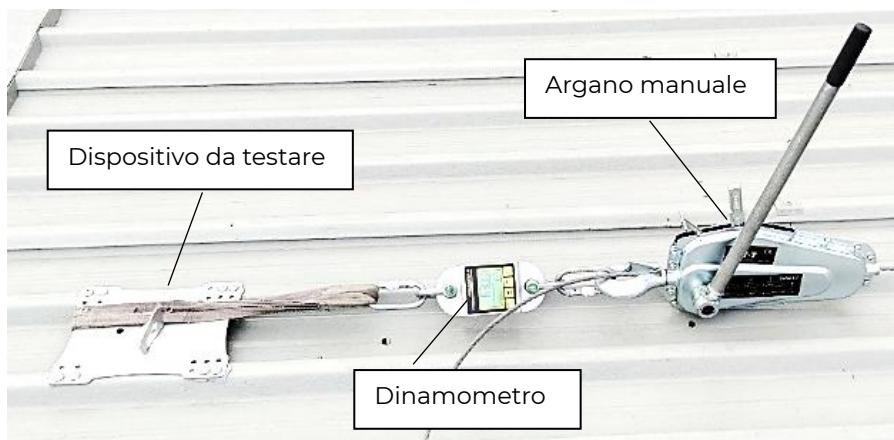
Qualora si volessero eseguire delle prove di collaudo sui dispositivi di tipo C installati, LineaVita by Co.M.Ed. SRL consiglia di eseguirle secondo le modalità e le intensità riportate nelle tabelle sotto:
