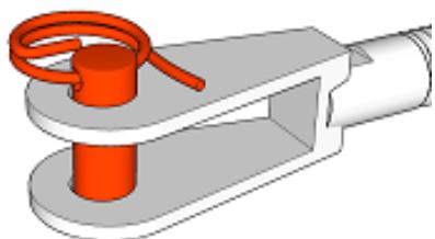
Rimuovere la coppia di sicurezza e rimuovere il perno di fissaggio della forcella del tenditore.
